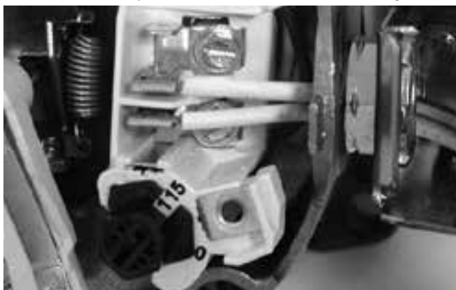
Figure 9 - Tension réglée à 115 V sur sélecteur à cadran
