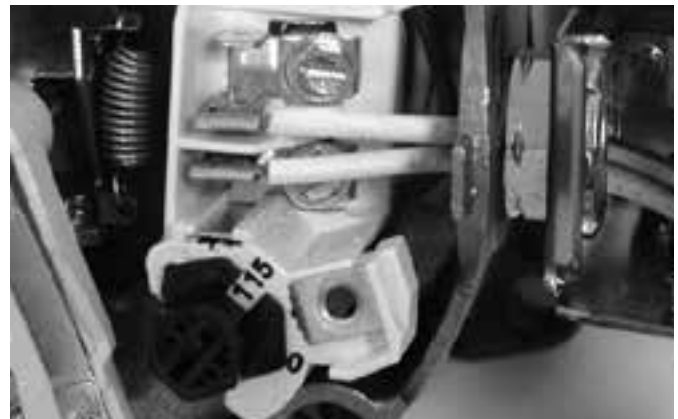
Figura 9 - Tensión configurada para 115 V, tipo cuadrante.
