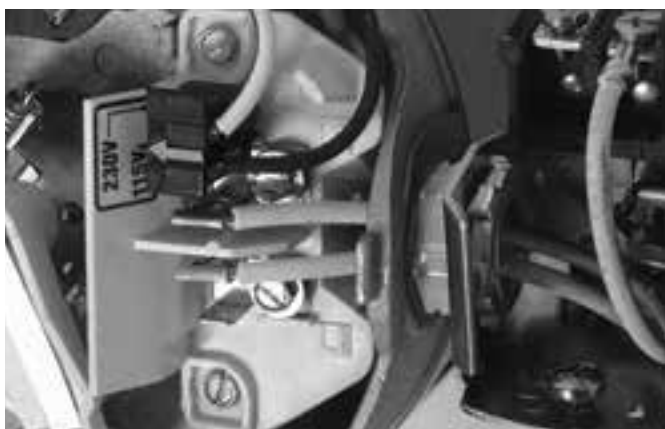
Figure 7 - Tension réglée à 115 V sur sélecteur à fiche
