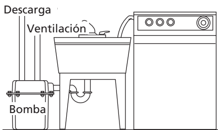
Figura 10 - Instalación típica en lavaderos y lavarropas
