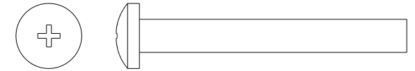
1/4-20 x 2 Pan Head Machine Screw 1/4-20 x 2 pan tornillo cabeza de la máquina 1/4-20 x 2 pan vis à métaux à tête
